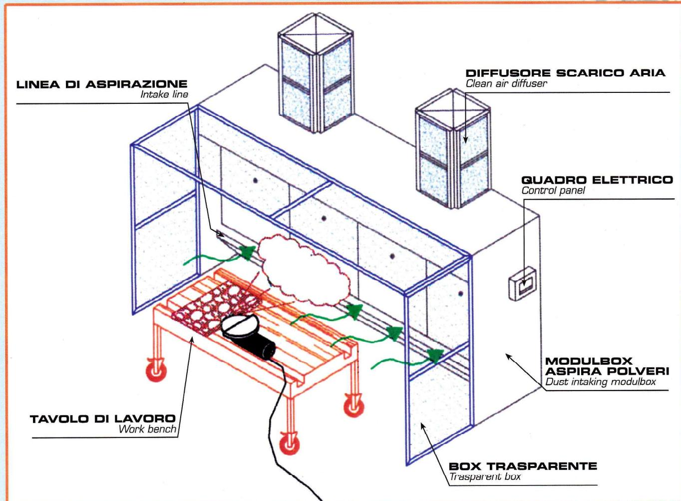
Il modulo aspirapolveri risolve le esigenze di aspirazione della polvere prodotta dalla lavorazione del marmo e del granito. Il funzionamento è molto semplice: l'aria carica di polvere viene aspirata dai ventilatori interni del modulo e fatta filtrare attraverso dei veli d'acqua; la polvere appesantendosi per mezzo dell'acqua assorbita precipita nella vasca sottostante piena d'acqua abbattendosi completamente.
